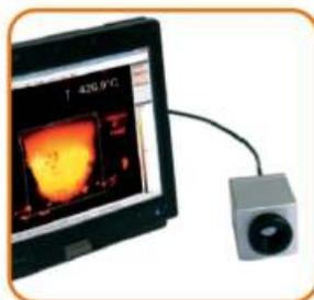
termómetros portatiles\_Alta calidad de termómetros infrarrojos con interfaz USB integrada.
